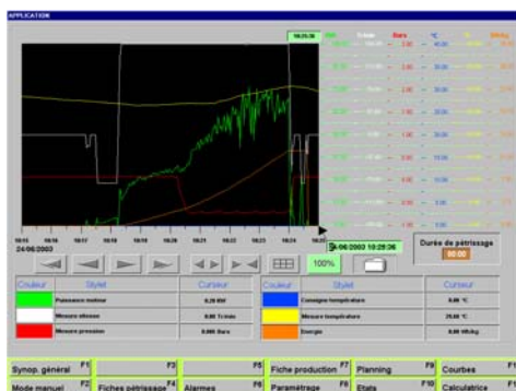
Exemple de mesures réalisées en temps réel par un pétrin horizontal sous vide VeryMix III Courbes de Puissance, Energie, Température, Vitesse de rotation
